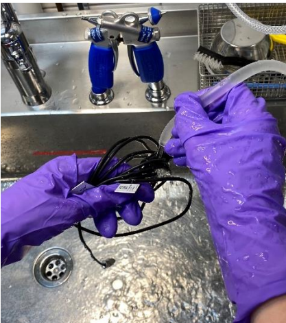
4. Slutsköljning med RO-vatten
