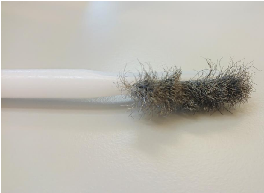
- NÄR STÅLBORSTEN SER VÄLDIG SLITEN UT, DET VILL SÄGA TRÅDARNA ÄR SOM PÅ BILD 2.
