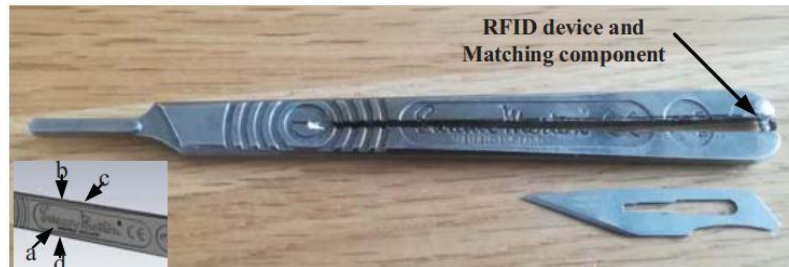
Figur 8: knivskaft som inbäddad med UHF RFID tagg (Taylor och Batchelor 2020).
