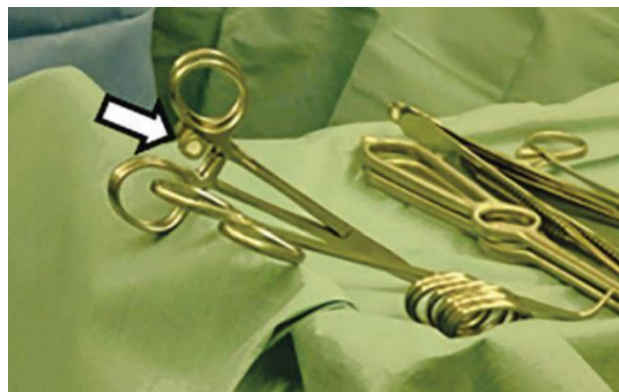
Figur 5: RFID taggar på instrument och jiggarna (vit pil) (Yamashita et al. 2019).
